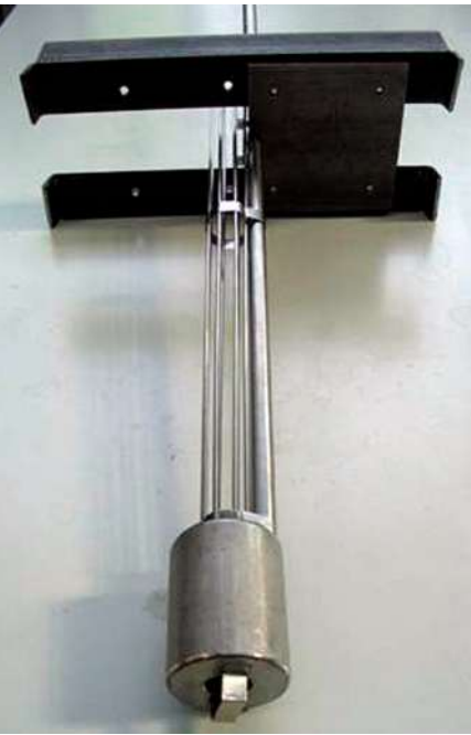
Bild 1: Sensor zur Überwachung des Bainitisierens bei zylindrischen Werkstücken. Damit werden die üblichen, enormen Zeitaufschläge zur Sicherstellung der kompletten Gefügeumwandlung überflüssig.
